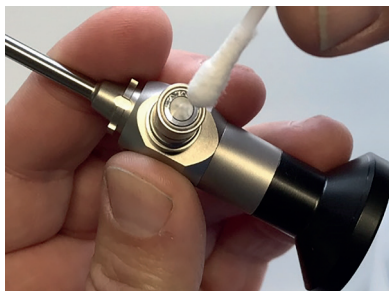
Fig. 3: Pulizia dell'attacco della guida di luce
