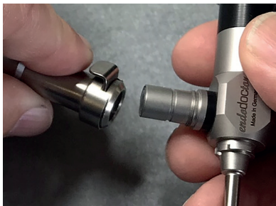
Fig. 6: Tilkobling av en lyslederkabel med klikkmekanisme (kompatibel med *Wolf). Fjern den første hylsen på lyslederkabelen for å gjøre dette
