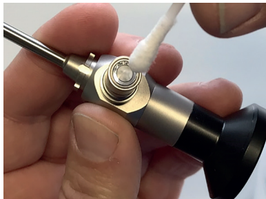
Obr. 3: Čištění adaptéru světlovodu
