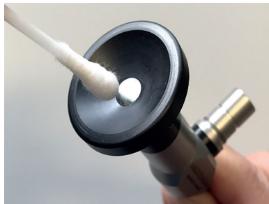
Fig. 4 : Nettoyage de la fenêtre proximale
