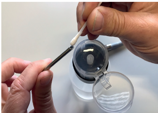
Obr. 2: Čištění distálního konce
