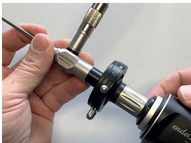
Fig. 9: Feste av et endoskopikamera til standardisert okulartrakt
