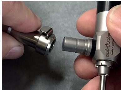
Fig. 6: Collegamento di un cavo a fibre ottiche con meccanismo a scatto (compatibile con *Wolf). Rimuovere la prima guaina dell'attacco del cavo a fibre ottiche
