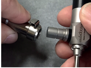
Şek. 6: Bir fiber optik kablonun mandallı mekanizmayla (*Wolf ile uyumlu) bağlanması. Fiber optik kablo bağlantısının ilk manşonu sökülür
