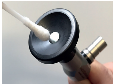
Fig. 4: Het proximale venster reinigen
