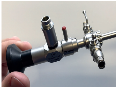
Obr. 8: Obě součásti lze pevně spojit otočením zajišťovací páčky ve směru hodinových ručiček. Spojení se uvolní otočením zajišťovací páčky proti směru hodinových ručiček.
