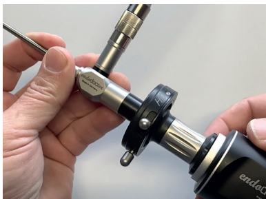
Fig. 9: Een endoscopiecamera op de gestandaardiseerde oculairtrechter plaatsen
