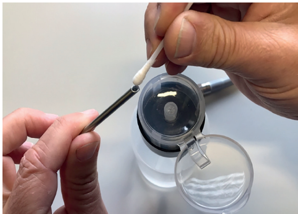
Fig.2: Rengøring af den distale ende
