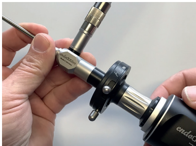
Fig. 9 : Mise en place d'une caméra endoscopique sur l'entonnoir de l'oculaire normalisé
