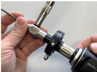
Abb. 9: Aufsetzen einer Endoskopie Kamera am genormten Okulartrichter
