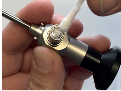
Abb.3: Reinigen des Lichtleiteransatzes
