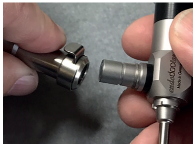
Fig. 6: Aansluiting van een glasvezelkabel met klikmechanisme (compatibel met *Wolf). De eerste huls van het glasvezelkabelhulpstuk wordt verwijderd
