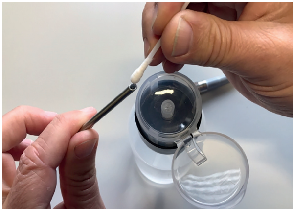
Fig. 2: Het distale uiteinde reinigen
