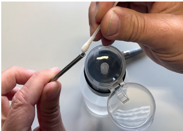
Abb.2: Reinigen des distalen Endes
