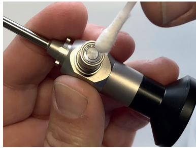
Fig. 3 : Nettoyage de la fixation du guide optique
