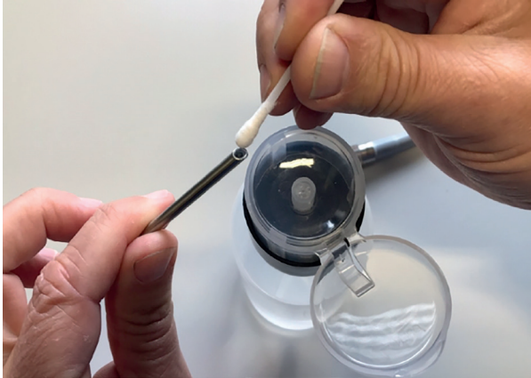
Şek. 2: Distal ucun temizlenmesi
