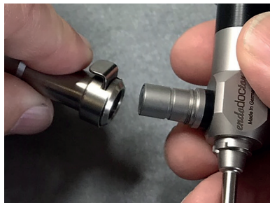
Fig.6: Tilslutning af et lyslederkabel med snapmekanisme (kompatibelt med *Wolf). Til dette formål fjernes den første muffe på lysledertilslutningen
