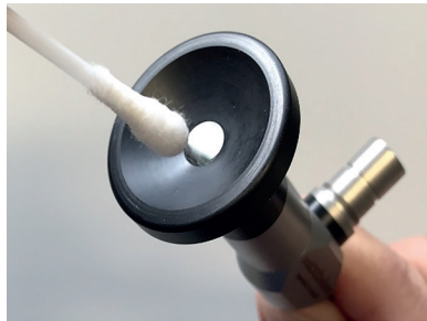
Abb.4: Reinigen des Proximalen Fensters
