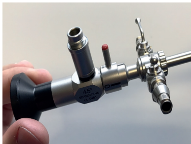
Fig.8: Båda komponenterna kan kopplas samman genom att låsspaken vrids medurs. På motsvarande sätt lossas anslutningen genom att låsspaken vrids moturs.
