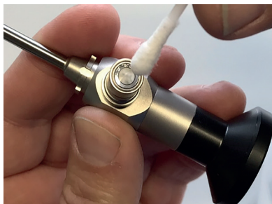
Рис. 3. Очистка крепления световода
