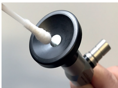
Fig.4: Rengöring av det proximala fönstret
