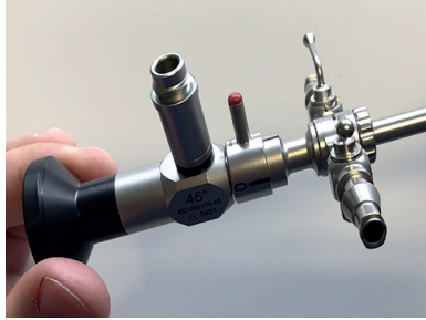
Şek. 8: Her iki bileşen de kilitleme kolu saat yönünde döndürülerek sıkıca bağlanabilir. Buna uygun olarak bağlantı, kilitleme kolu saat yönünün tersine döndürülerek açılır.
