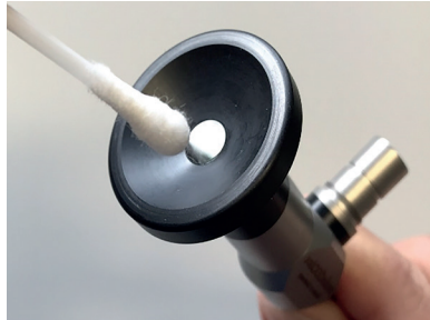
Fig. 4: Limpieza de la ventana proximal
