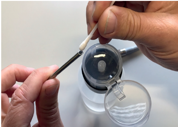
Fig. 2: Limpieza del extremo distal
