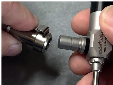
Fig.6: Anslutning av en ljusledarkabel med snäppmekanism (kompatibel med *Wolf). För detta tas den första hylsan på ljusledaranslutningen bort
