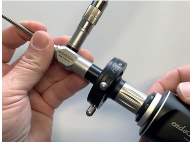
Şek. 9: Endoskopi kamerasının standartlaştırılmış oküler huninin üzerine yerleştirilmesi
