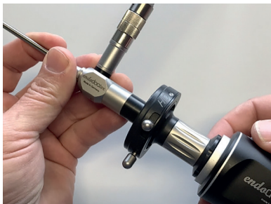
Fig. 9: Montering af et endoskopikamera på den standardiserede okulartragt
