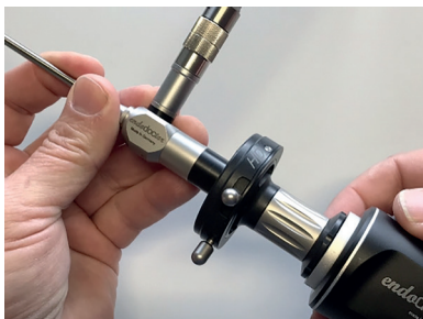
Fig. 9: Plasarea unei camere endoscopice pe pâlnia standard a ocularului
