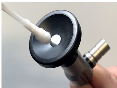
Fig. 4: Pulizia della finestra proximale
