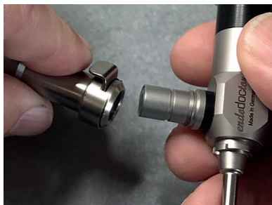
Рис. 6. Соединение оптоволоконного кабеля с защелкой (совместим с *Wolf). Первая муфта крепления оптоволоконного кабеля удалена
