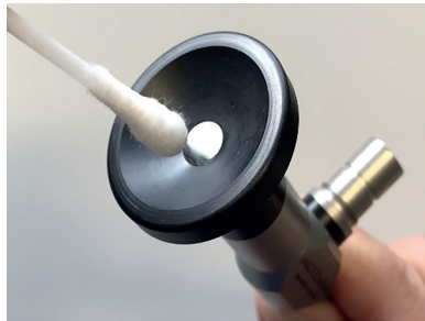
Sl. 4: Čišćenje proksimalnog prozora
