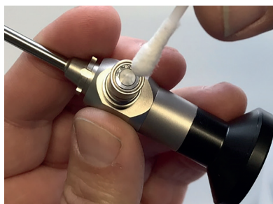
Рис. 3. Очистка крепления световода
