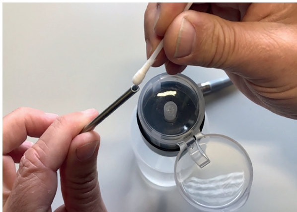
Fig.2: Rengöring av den distala änden
