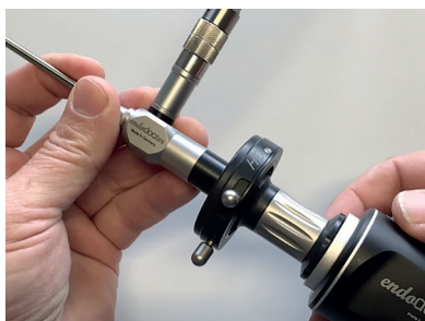
Kuva 9: Endoskooppikameran asettaminen standardimuotoiseen okulaarisuppiloon
