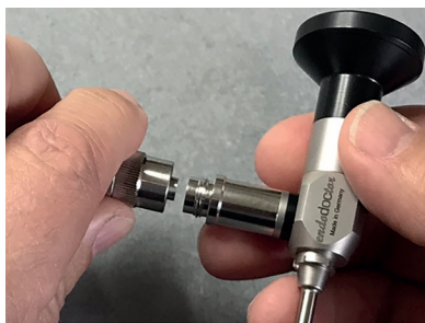
Фиг. 5: Свързване на фиброоптичен кабел с резба (съвместим с доставчиците *Storz, *Olympus)
