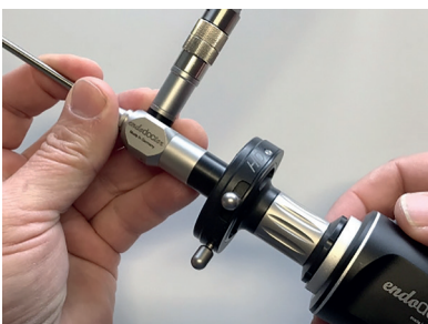
Obr. 9: Umístění endoskopické kamery na standardizovaný trychtýř okuláru
