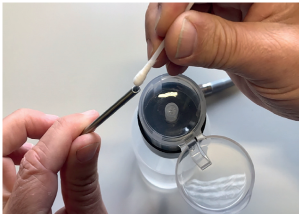
Sl. 2: Čišćenje distalnog kraja
