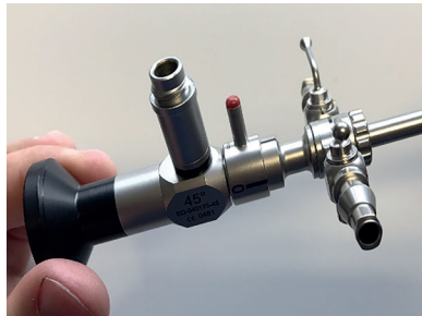
Εικ. 8: Τα δύο εξαρτήματα μπορούν να συνδεθούν σταθερά περιστρέφοντας τον μοχλό ασφάλισης δεξιόστροφα. Αντίστοιχα, η σύνδεση απελευθερώνεται περιστρέφοντας τον μοχλό ασφάλισης αριστερόστροφα.
