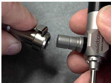
Rys. 6: Zatrzaskowe łączenie kabla światłowodowego (kompatybilne z Wolf). Pierwsza tuleja mocowania kabla światłowodowego została usunięta
