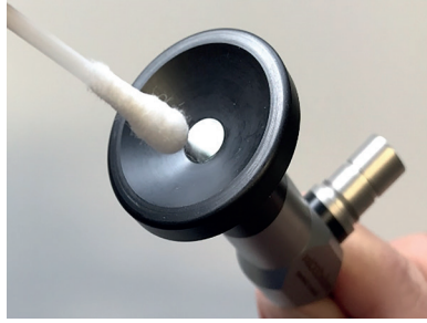
Şek. 4: Proksimal Pencerenin temizlenmesi
