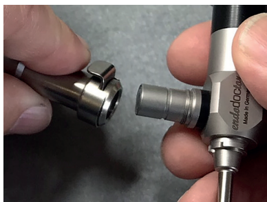
Фиг. 6: Свързване на фиброоптичен кабел със зашракващ механизъм (съвместим с *Wolf). Първата втулка на приставката на фиброоптичния кабел е отстранена
