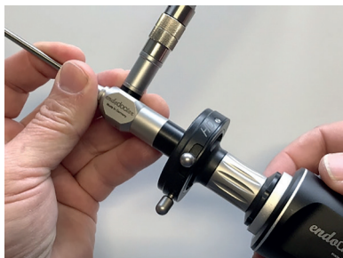
9. ábra: Az endoszkópos kamera felhelyezése a szabványos okulártölcsérre
