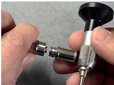
Sl. 5: Priključivanje svjetlovodnog kabela s navojem (kompatibilno s dobavljačima *Storz, *Olympus)
