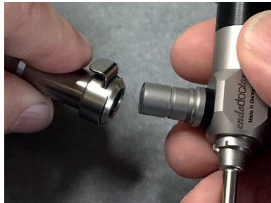
Kuva 6: Valokuitukaapelin liitäntä, jossa on napsautusmekanismi (yhteensopiva *Wolfin kanssa). Valokuitukaapelin kiinnikkeen ensimmäinen holkki irrotetaan
