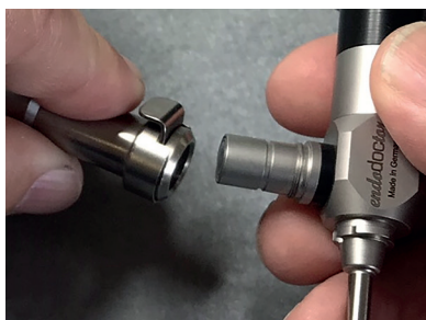
Slika 6: Priključitev optičnega kabla z zaskočnim mehanizmom (združljivo z izdelki znamke *Wolf). Prvi tulec priključka optičnega kabla je odstranjen
