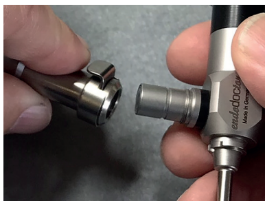
Obr. 6: Pripojenie optického kábla so západkovým mechanizmom (kompatibilné s výrobkami *Wolf). Odstráni sa prvá objímka nastavca optického kábla
