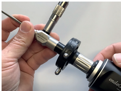
Εικ. 9: Τοποθέτηση κάμερας ενδοσκόπησης στην τυποποιημένη χοάνη προσοφθάλμιου φακού
