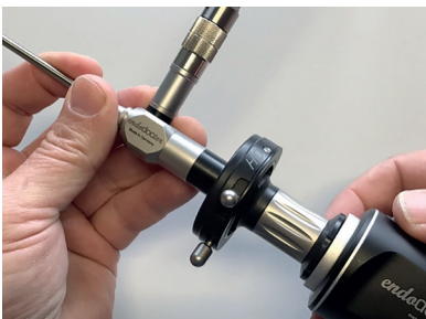
Rys. 9: Umieszczenie kamery endoskopowej na znormalizowanym lejku okularu
