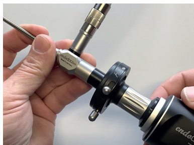
Fig. 9: Een endoscopiecamera op de gestandaardiseerde oculairetrechter plaatsen
