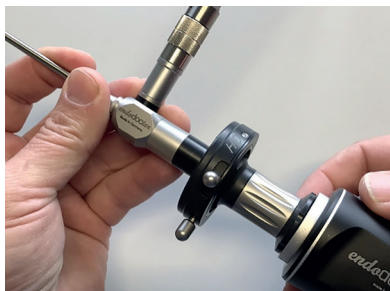
Slika 9: Namestitev endoskopske kamere na standardizirani lijak okularja
