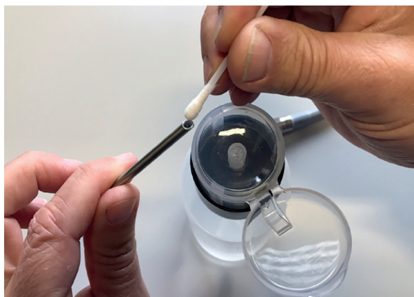
Sl. 2: Čišćenje distalnog kraja
