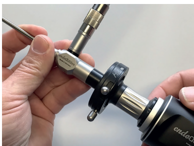
Рис. 9. Размещение эндоскопической камеры на стандартизированной окулярной воронке
