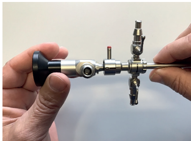
Fig.7: Når endoskopet indføres i skaftet, skal det sikres, at markeringerne på skaftet og endoskopet stemmer overens. I disse positioner kan komponenterne skubbes sammen
