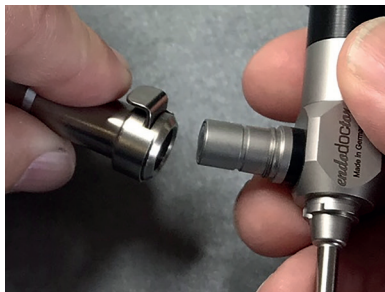
6. ábra: Optikai kábel csatlakoztatása pattintó mechanizmussal (Wolf-kompatibilis). Az optikai kábel rögzítésének első hüvelyé eltávolításra kerül
