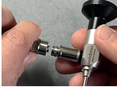
Şek. 5: Bir fiber optik kablonun dişliyle (*Storz, *Olympus tedarikçileriyle uyumlu) bağlanması
