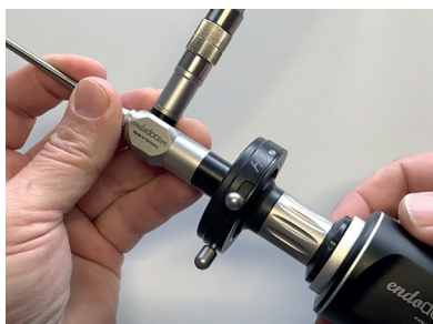
Obr. 9: Umiestnenie endoskopickéj kamery na štandardizovaný lieviek okulára
