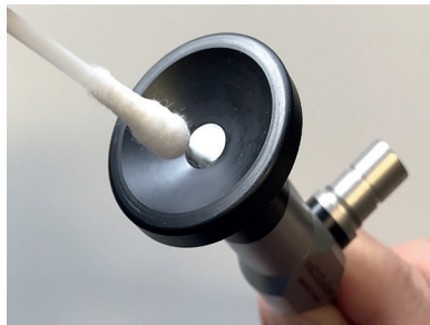
Fig. 4: Rengjøre det proximale vinduet
