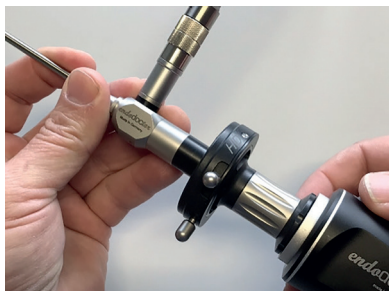
Фиг. 9: Поставяне на ендоскопска камера върху стандартна фуния на окуляра
