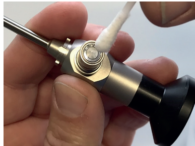
Obr. 3: Čištění adaptéru světlovodu
