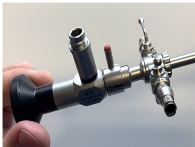
Sl. 8: Obje komponente mogu se čvrsto spojiti okretanjem poluge za blokiranje u smjeru kazaljke na satu. Sukladno tome, spoj se otpušta okretanjem poluge za blokiranje u smjeru suprotnom od kazaljke na satu.
