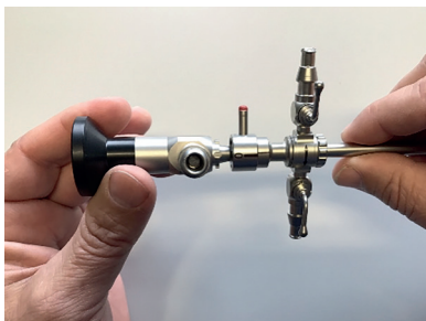
Kuva 7: Kun asetat endoskoopin varteen, varmista, että varren ja endoskoopin merkinnät vastaavat toisiaan. Näissä asennoissa osat voidaan työntää yhteen
