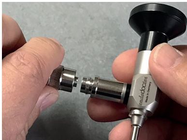
Εικ. 5: Σύνδεση καλωδίου οπτικών ινών με σπείρωμα (συμβατό με τους προμηθευτές *Storz, *Olympus)
