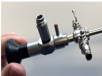
Fig. 8 : Les deux composants peuvent être fermement fixés en tournant le levier de verrouillage dans le sens horaire. Pour libérer la connexion, tournez le levier de verrouillage dans le sens antihoraire.
