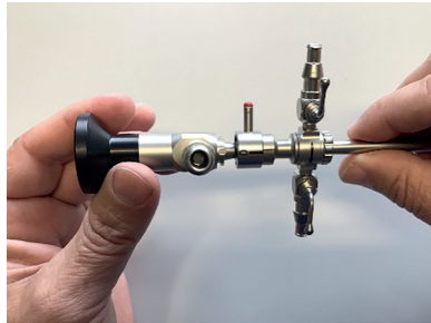
7. ábra: Az endoszkóp szárba történő behelyezéséhez ügyeljen arra, hogy a szár és az endoszkóp jelölései egyezzenek. Ezekben a pozíciókban az alkatrészek összerakhatók
